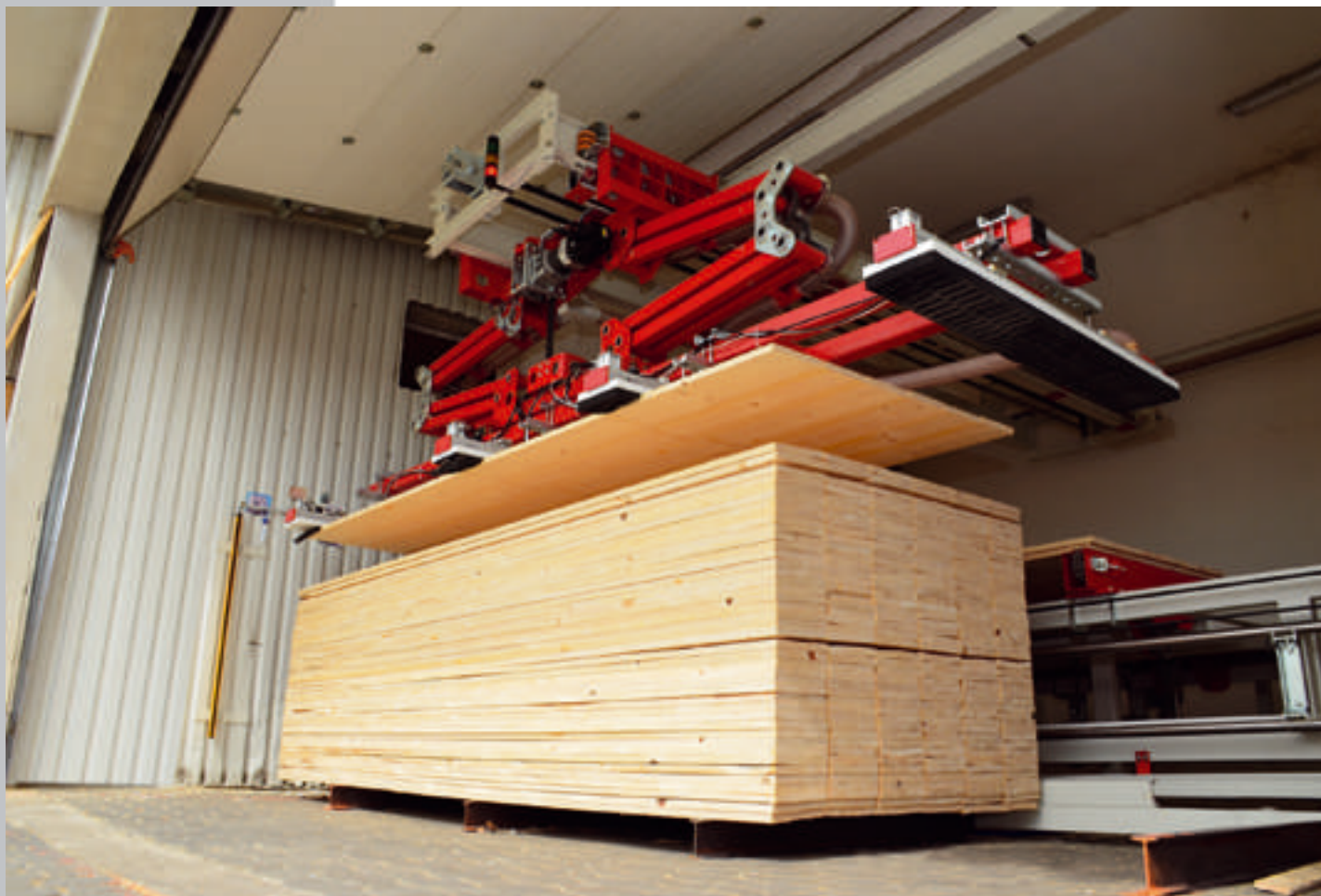
Vakuový manipulátor se shrnovačem překladů ke stroji KP 900 EASY CUT
